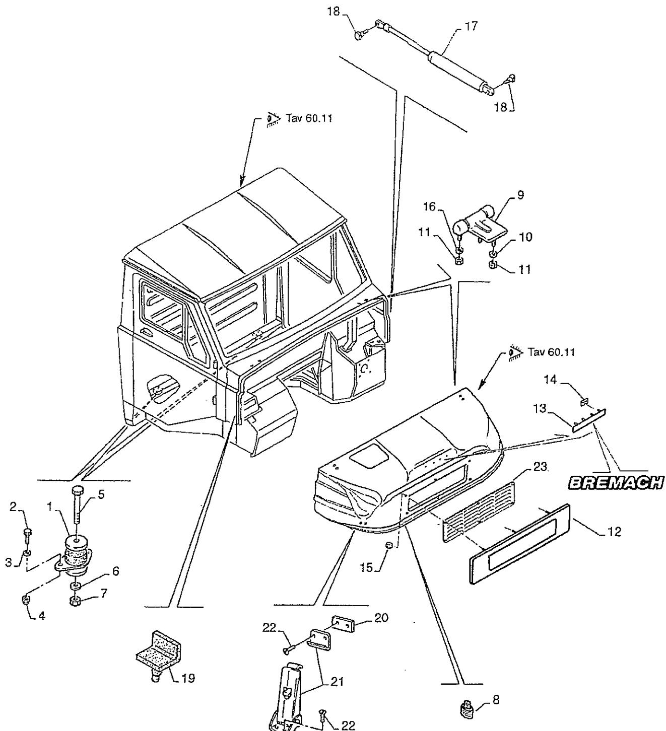
**BREMACH**Componenti vari cabina singola
