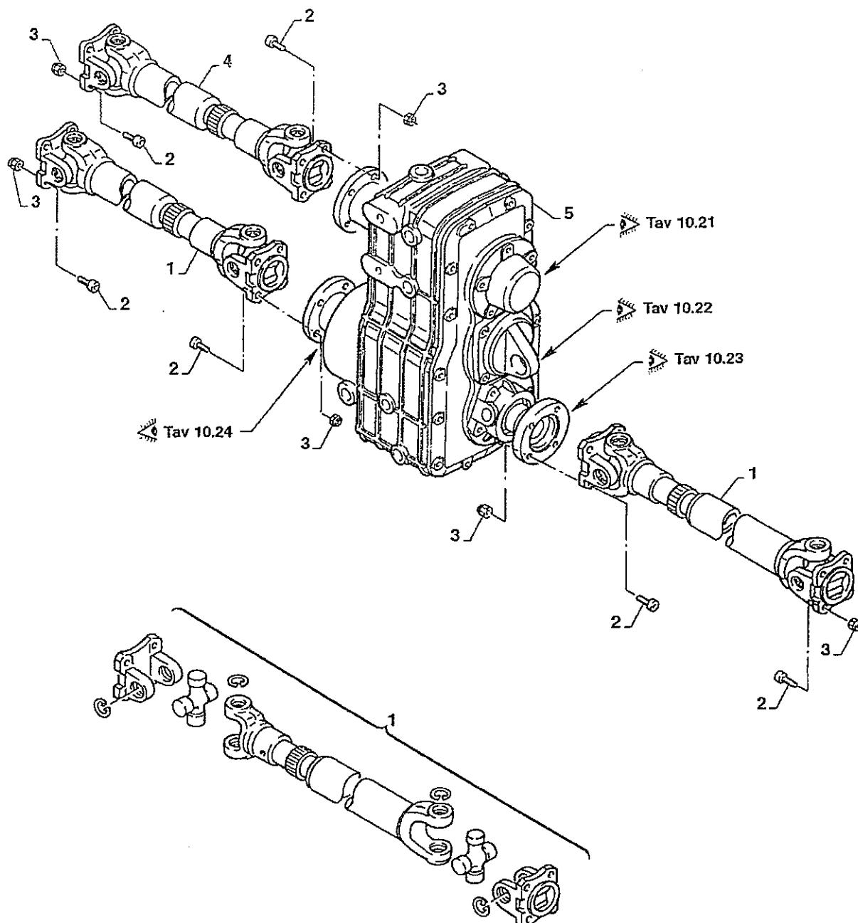
**BREMACH**Alberi di trasmissione passo 2600
