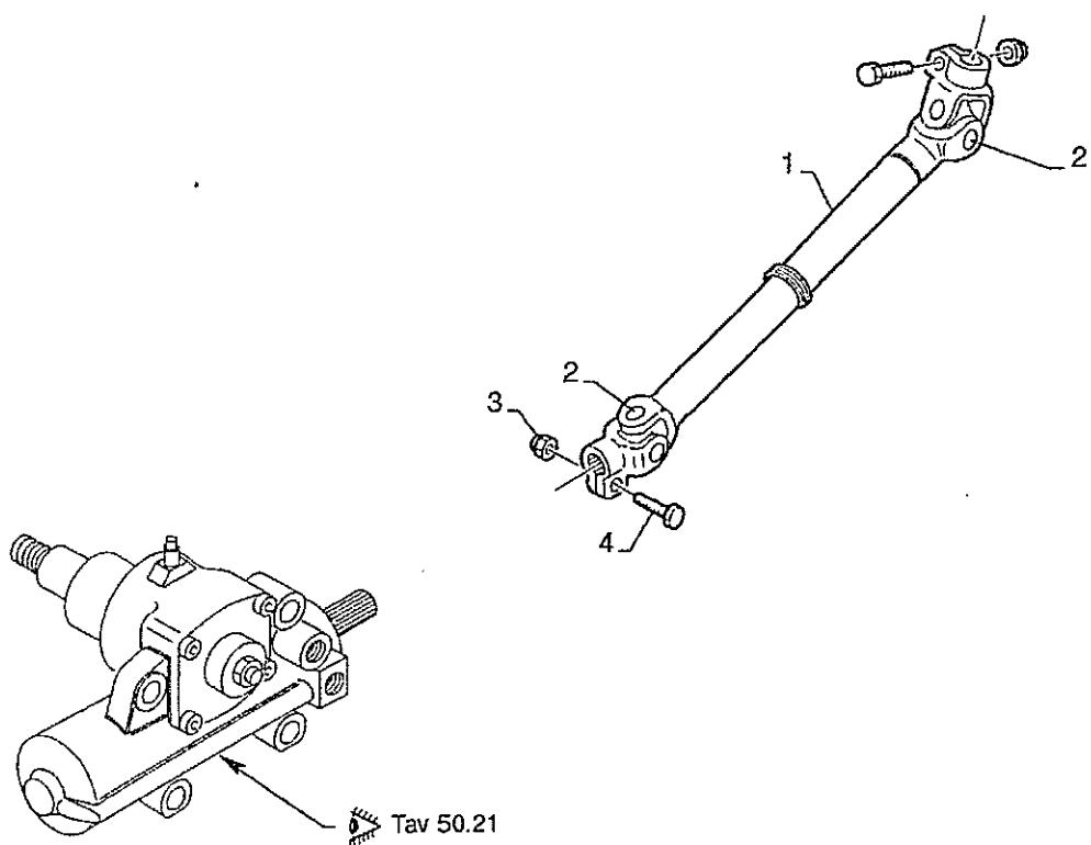
**BREMACH**Idroguida / piantone sterzo
